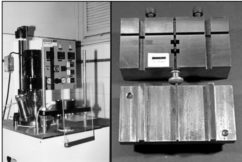
Figura 2 - Injetora e molde utilizados.
